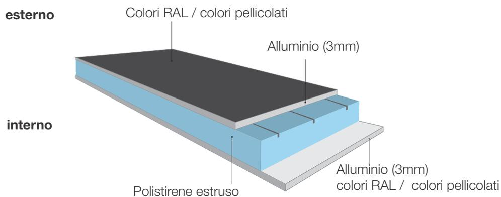
I pannelli **ELITE** e **ELITE+** sono composti da da 2 lastre in alluminio con spessore di 3mm. Entrambi i tipi di pannelli hanno all'interno schiuma di polistirene estruso, che assicura un isolamento termico superiore. I pannelli **ELITE** sono utilizzati per i profili in PVC con anta classica, con clips in alluminio all'esterno sul telaio e sull'anta. I pannelli **ELITE+** sono utilizzati per i profili in PVC con anta a scomparsa, con clips in alluminio all'esterno sul telaio.
